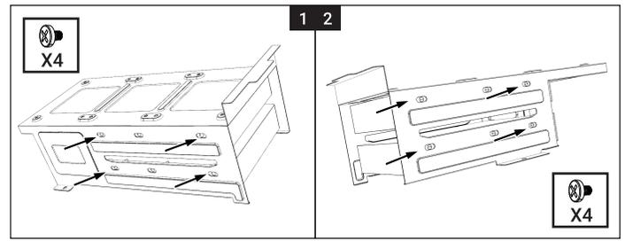
PSU Installation/Installation du bloc d'alimentation/電源安裝/电源安裝
