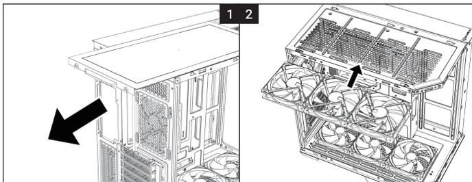
Fan (Bottom) Installation/Installation du ventilateur inférieur
