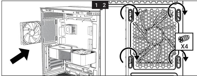
MB Tray Installation/Installation du ventilateur avant
